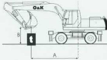
Gemäß ISO 10567 betragen die genannten Werte 75% der statischen Kipplast oder 87% der hydraulischen Hubleistung. Die Werte gelten bei aktiviertem Kraftverstärker.
