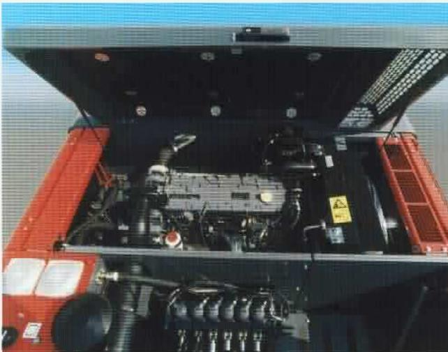
Die gute Zugänglichkeit zum Motor und allen Aggregaten verkürzt die Wartungs-Zeit und steigert die Produktiv-Zeit. Alle Servicepunkte sind schnell und sicher zu erreichen. So ist die tägliche Wartung ruck-zuck erledigt. Langzeit-geschmierte Komponenten, wie z.B. die voll gekapselte Kugeldrehverbindung, sorgen für lange Wartungsintervalle.
