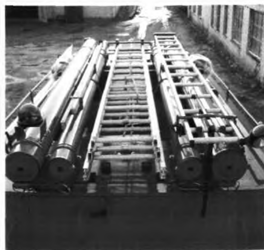
Размещение ПТВ на надстройке
