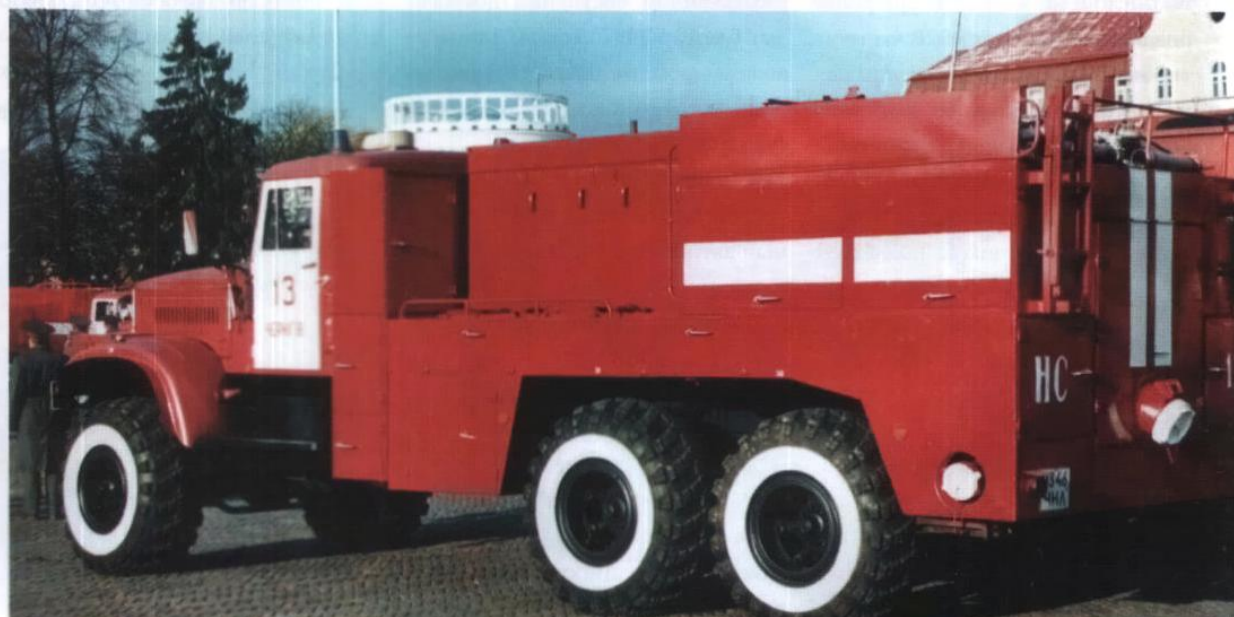
Передвижная насосная станция ПНС-110(255Б1)-259
