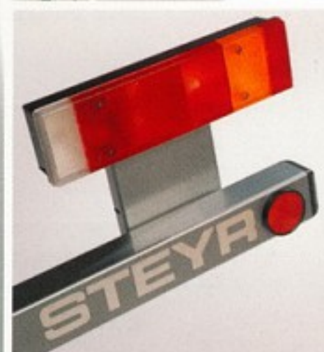
6-kamer achterlichten: lampen met geïntegreerde achteruitrijlamp en mistachterlicht.
