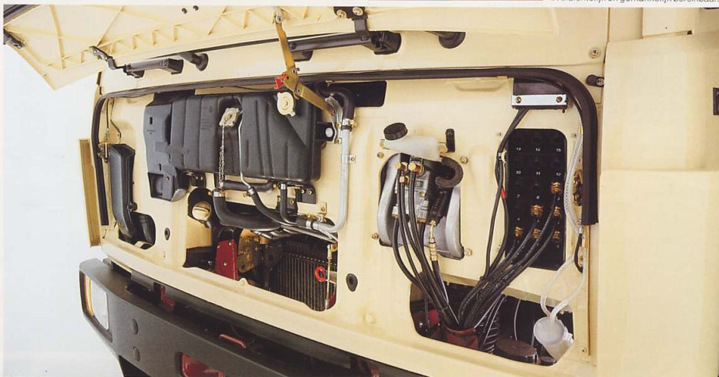
De onderhoudsklep – alle aggregaten voor de dagelijkse controle zijn op één plaats onderbracht.
