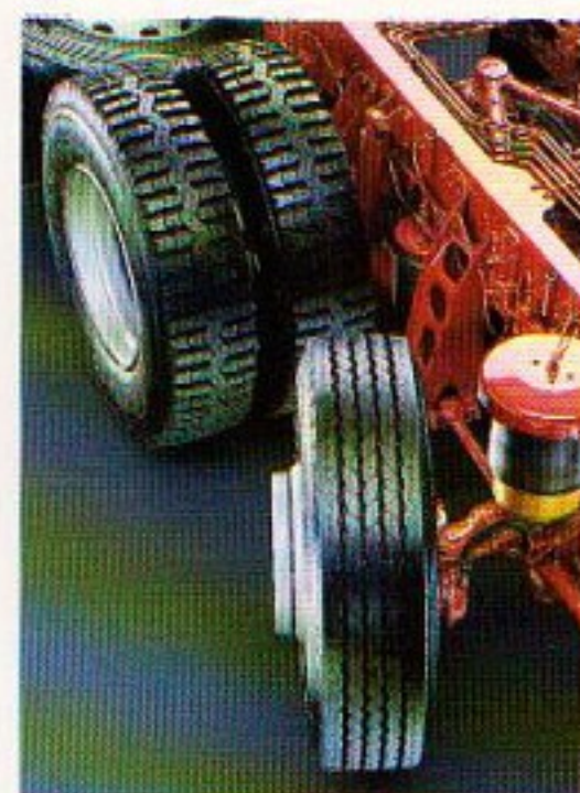
Selbstlenkende Nachlaufachse mit Einzelradauf- hängung und Luft- federung.
