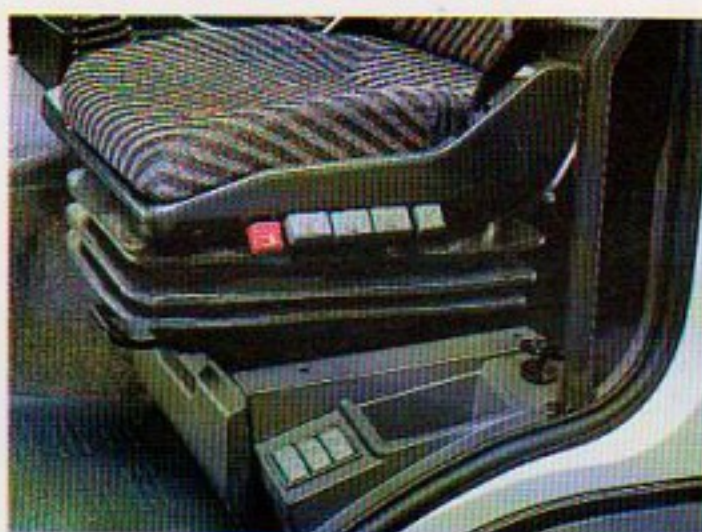
Fahrerfreundlich: Höhen- und neigungsverstellbares Lenkrad, luftgefederter, längs- und höhenverstellbarer Sitz mit variabler Rückenlehne und integriertem Sicherheitsgurt
