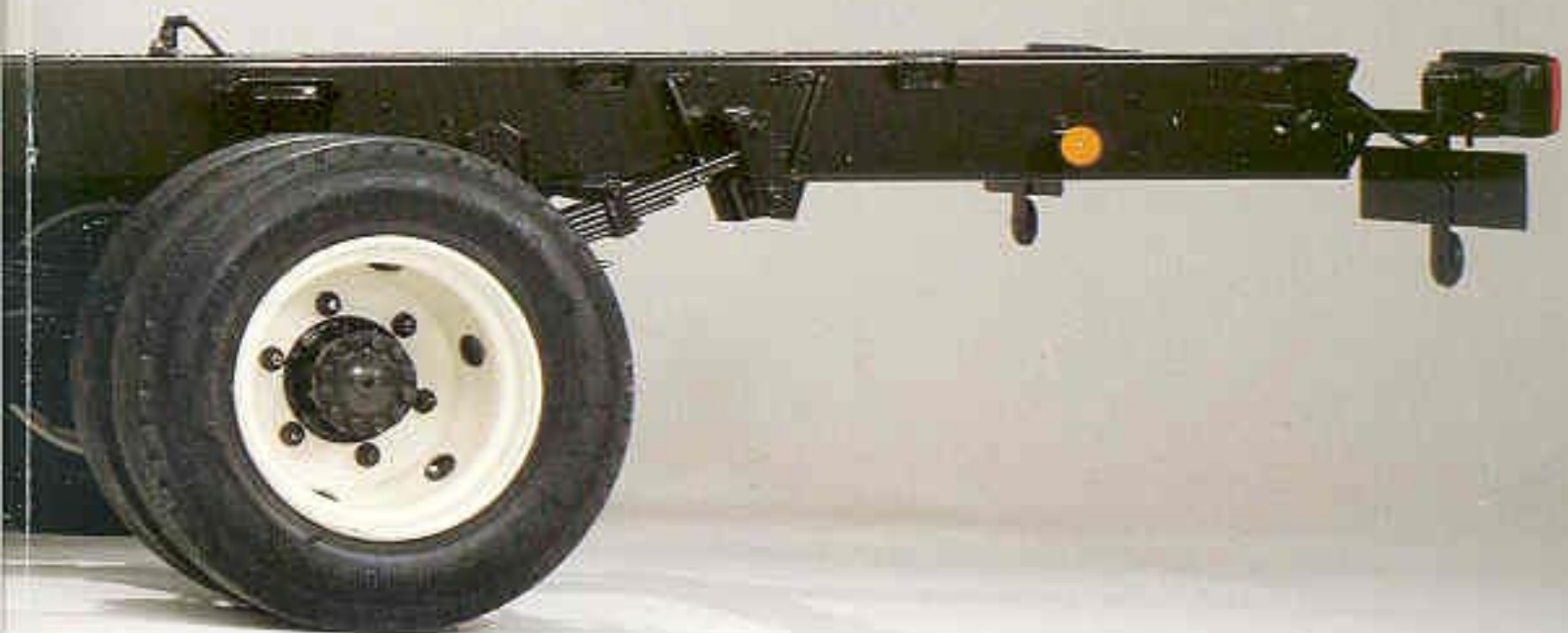
Soepele bladveren geven de MAN G-90 een soepele veerarakteristiek. De bladvering wordt standaard gemonteerd.
