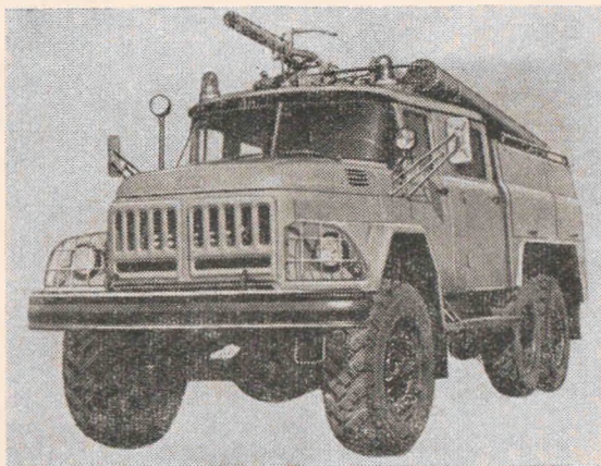
Рис. 1. Автоцистерна пожарная АЦ-40(131), модель 137
