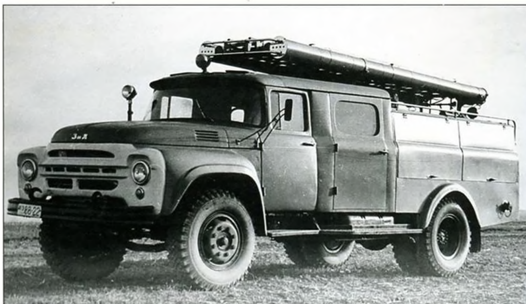
Опытный образец АЦ-30(130)-63, созданный ОКБ-8 в 1962 г., по старинке называли ПМЗ-63. Автомобиль имеет облицовку радиатора белого цвета.
