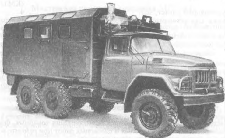
Рис. 302. Мастерская ремонтно-механическая МРМ
