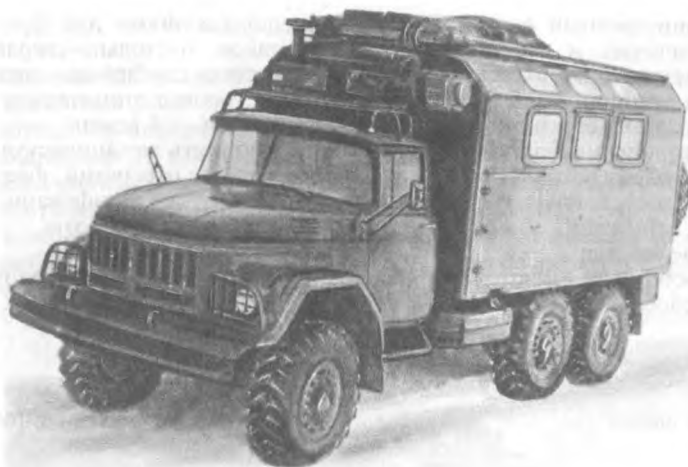
Рис. 301. Мастерская ремонтно-слесарная MPC-AT
