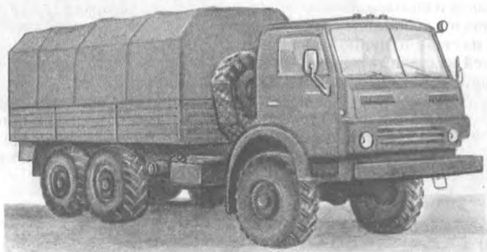
Рис. 308. Мастерская ремонта технических средств службы горючего МРТС СГ
