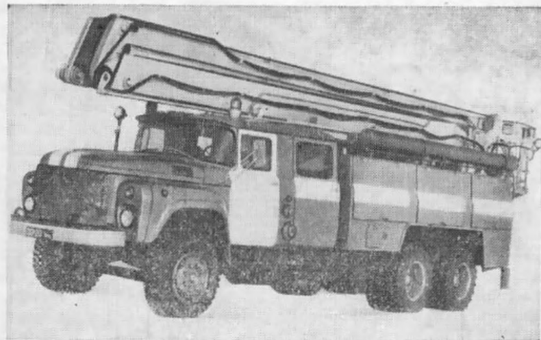
Пожарная автоцистерна АЦ-40 (133ГЯ) мод. 203 с коленчатым подъемником
