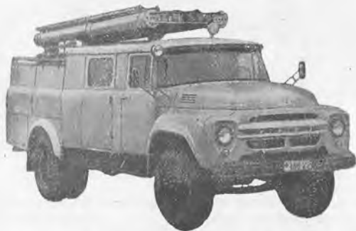
Рис. 34. Пожарный автонасос АН-30(130) на шасси ЗИЛ-130
