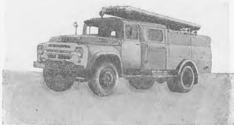
Рис. 22. Пожарная автоцистерна АЦ-30(130) на шасси ЗИЛ-130
