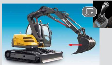
**COUPLAGE DE VÉRINS : Maniement de l'équipement en 3 parties sans l'usage de pédales** grâce au couplage de vérins (Brevet Mecalac).
