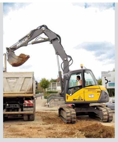
Grâce à la cinématique originale de son équipement et au système de relevage de flèche par deux vérins asymétriques, la 714MC décape et creuse avec précision et performance. De plus, grâce à une cabine spacieuse et un poste de conduite ergonomique, l'opérateur travaille dans des conditions optimales tout au long de la journée.
