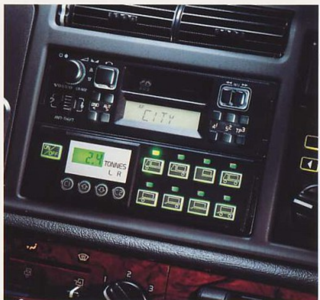
De nieuwe aslastindicator (optie tegen meerprijs) om optimaal gebruik te maken van het wettelijk GVW.
