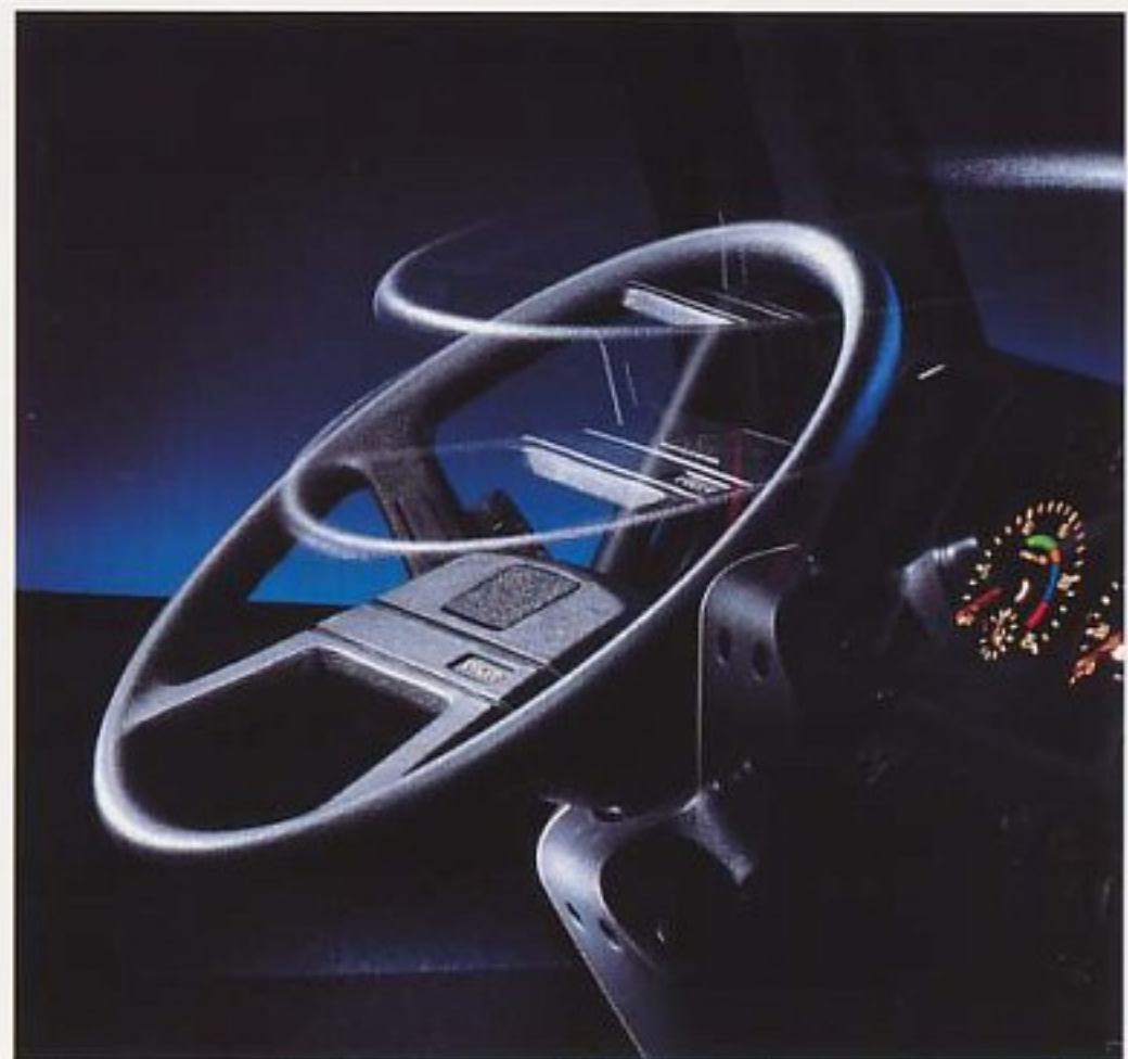
De hoogte en hoek van stuurwiel en stuurkolom zijn makkelijk te verstellen.
