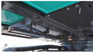
Der Rahmen ist ab Werk verstärkt, um das schwerere Gegengewicht zu tragen.
