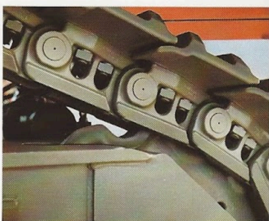
Die Kettenradausführung ohne scharfe Zahnsitzen reduziert die Gefahr von Zahnausbrüchen erheblich. Eine exakte Kettenführung ist gewährleistet. Denn die Ketten werden ständig automatisch nachgespannt.
