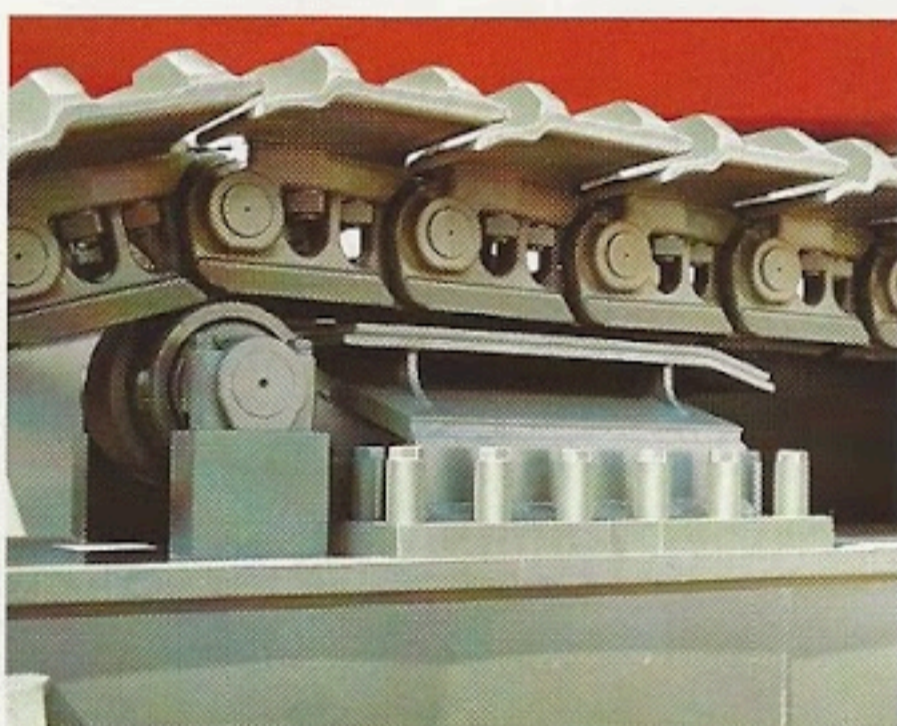
Das Mittelteil ist an den acht Auflegpunkten verwindungssteif mit dem Raupenträger verschraubt.
