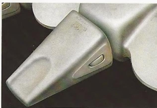
Flach und dennoch äußerst stabil: Die Schaufelschneide läßt die Kräfte am Zahn voll wirksam werden. Die auswechselbaren Zähne sind selbstschärfend. Zusätzliches Verschleißvolumen zwischen den Zähnen.
