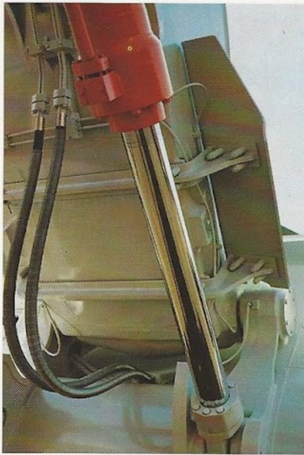
Serienmäßiger Schutz für die Schaufel-Zylinder durch sichere Abdeckung.
