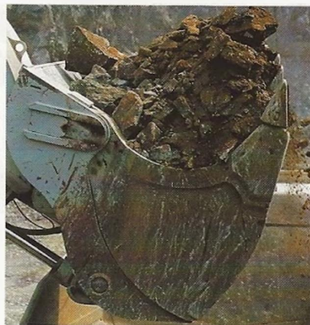
Die spezielle Schaufelform sichert eine stets volle Schaufel, da das Material bis in den oberen Schaufelbereich fließt. Die zurückgezogene Seitenwand verbessert das Eindringvermögen. Die spezielle Form der Stiel/Schaukel-Verbindung verhindert, daß herabfallendes Material hinter der Schaufel eingeklemmt wird.
