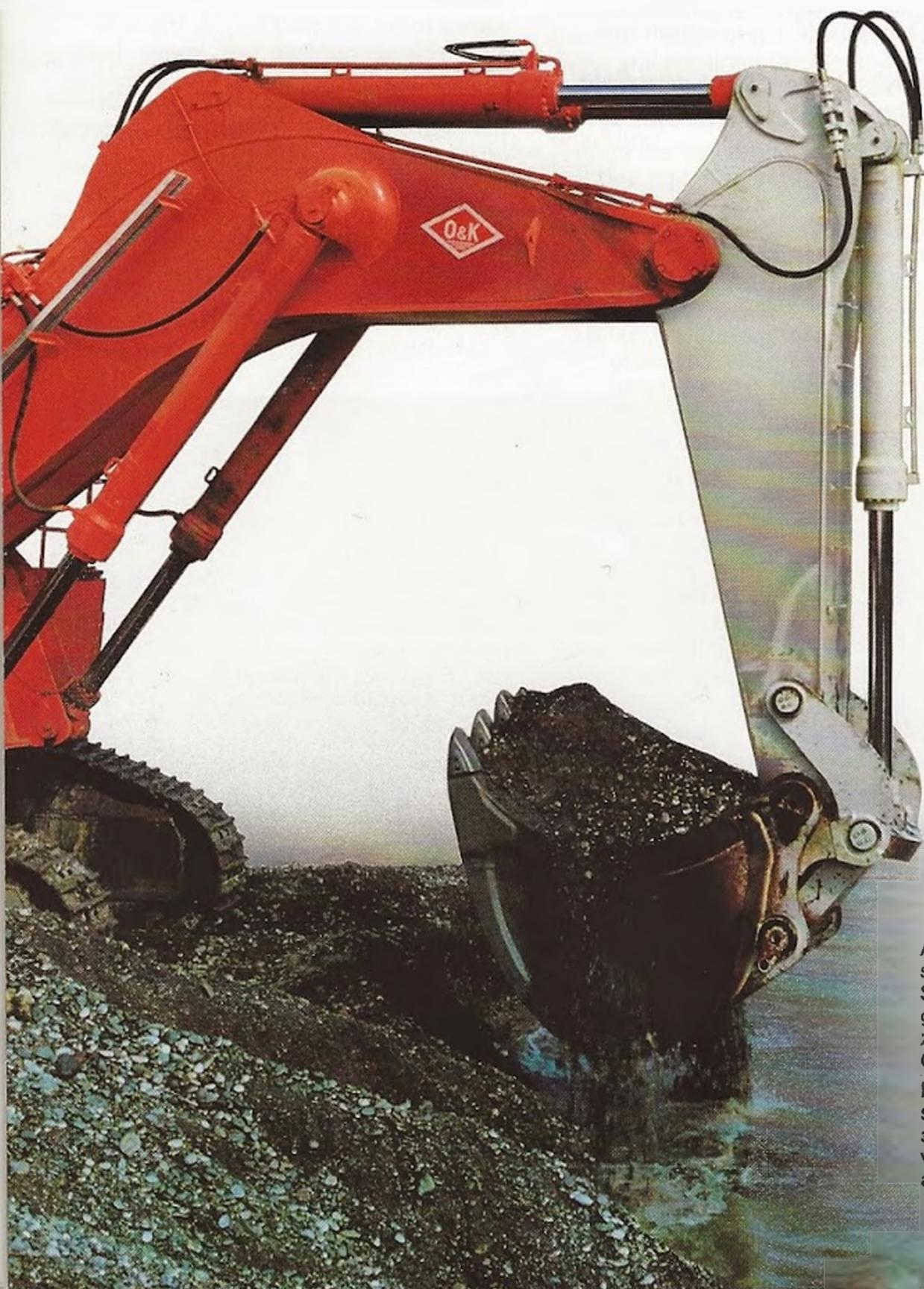
Ausleger und Stiel sind eine Ganzstahlkasten-Schweißkonstruktion aus hochfestem Stahl. Die Lagerstellen Ausleger/Oberwagen, Ausleger/Stiel und Stiel/Schaukel sind zur Erhöhung der Stabilität aus schweren Gußteilen.
