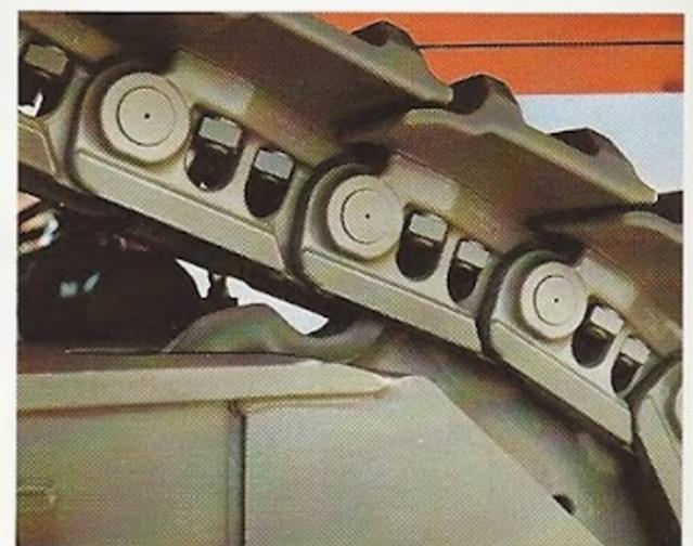
Die Kettenradausführung ohne scharfe Zahnschneidspitzen reduziert die Gefahr von Zahnausbrüchen erheblich. Eine exakte Kettenführung ist gewährleistet. Denn die Ketten werden ständig automatisch nachgespannt.
