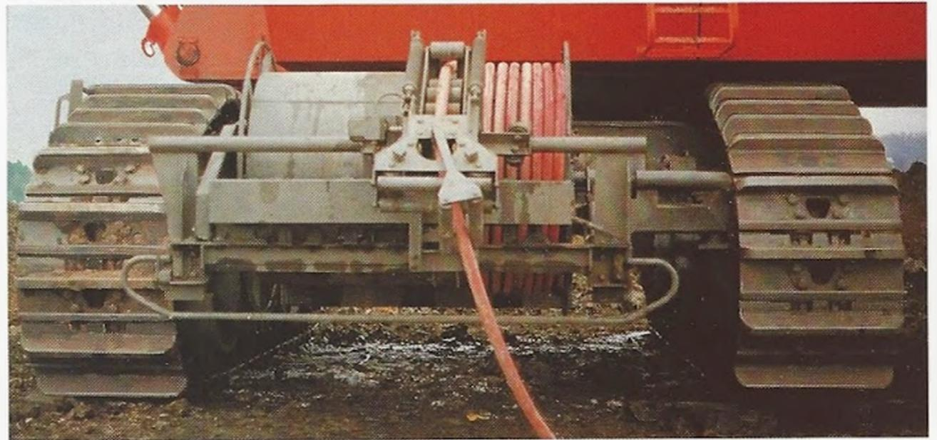
Der Elektrobagger besitzt eine serienmäßige Ölvorwärmung. Die Kabelzuführung für den E-Motor erfolgt entweder zwischen den Fahrschiffen oder an der linken bzw. rechten Seite des Unterwagens. Auf Wunsch ist die Montage einer Kabeltrommel möglich. Je nach Fahrbewegung wird das Kabel automatisch auf- bzw. abgewickelt.
