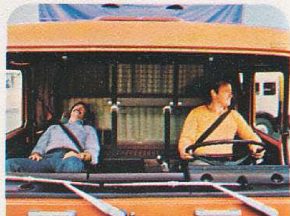
Achter de bijrijdersstoel is het bovenbed gedeeld. De bijrijdersstoel (met armleuningen en hoofdsteun) kan daardoor ver achterover worden gezet; een echte relax-stoel voor onderweg.
