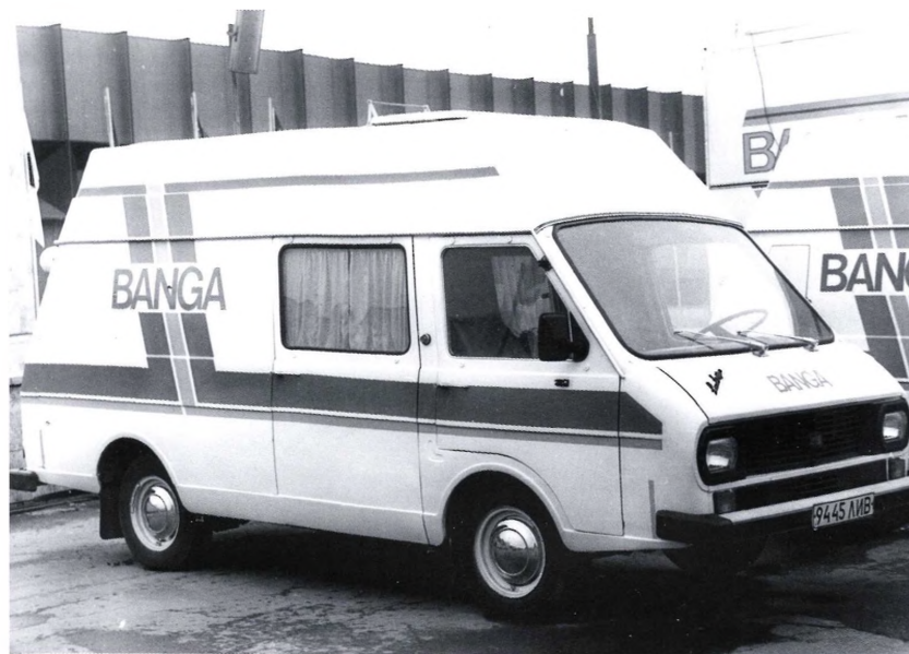
▲ Репортажная телевизионная станция на базе микроавтобуса РАФ
