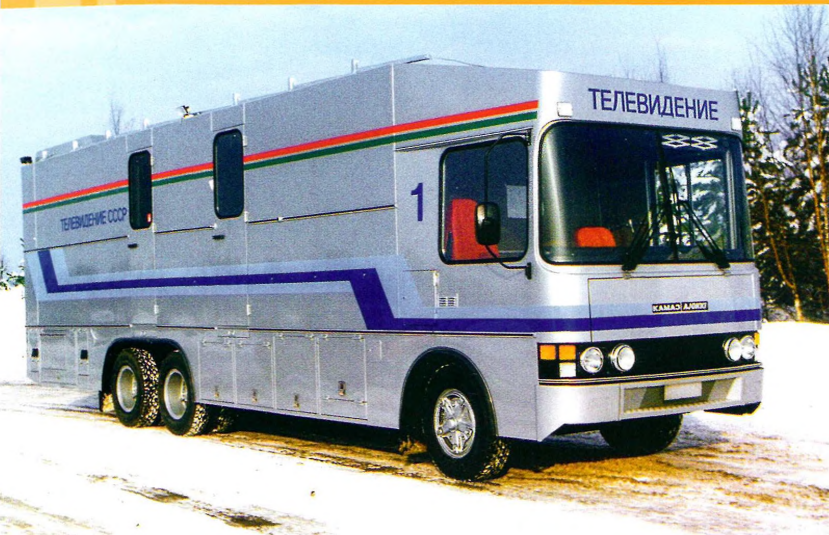
Телевизионная станция ПТС-ЦТ «Магнолия-83» в кузове «Айокки» на шасси КАМАЗ-53213
