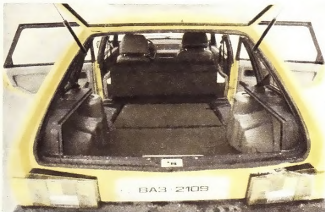
Как у ВАЗ-2108, кузов новой модели легко трансформируется в грузопассажирский. Его детали закрыты обивкой из пластика.
