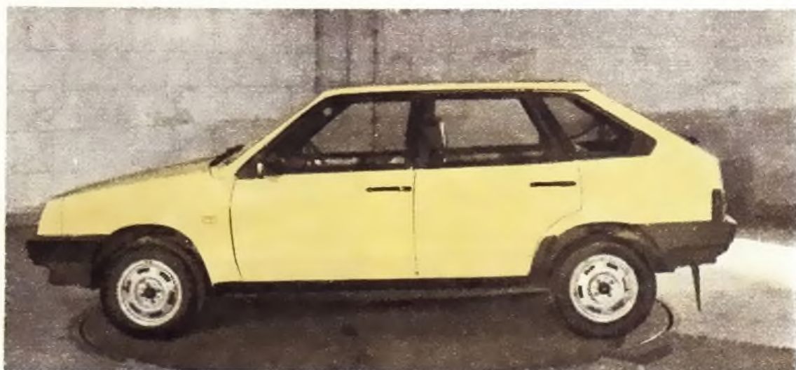
В знакомый контур боковины кузова вписаны теперь две двери и неоткрывающееся заднее окно. Изменилось расположение средней стойки, и передняя дверь стала менее широкой, чем у ВАЗ-2108.
