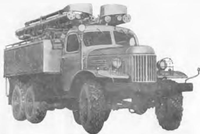
*Рис. 46. Пожарный автомобиль химического пенного пожаротушения АХП-2,А(157) на шасси ЗИЛ-157К*
