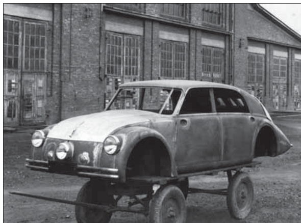
Karoserie Tatry 77a se před montáží převážely na vozíku.
