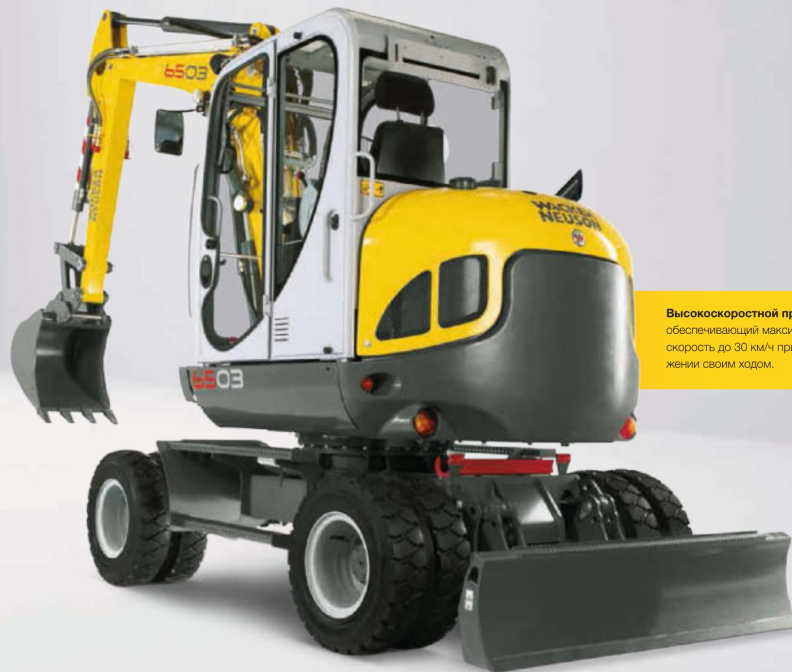
Высокоскоростной привод, обеспечивающий максимальную скорость до 30 км/ч при передвижении своим ходом.
