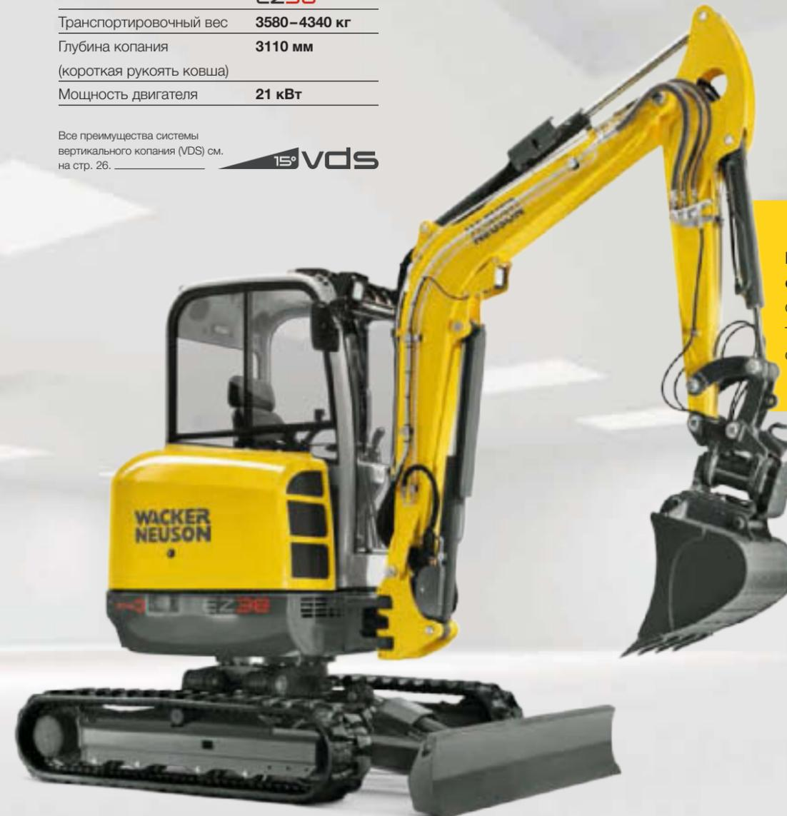
**В серийном исполнении с 2 скоростями Auto2Speed:** 2 скорости движения с автоматическим переключением, 2 скорость блокируется вручную.
