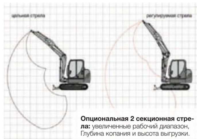
**Опциональная 2 секционная стрела:** увеличенный рабочий диапазон, Глубина копания и высота выгрузки.
