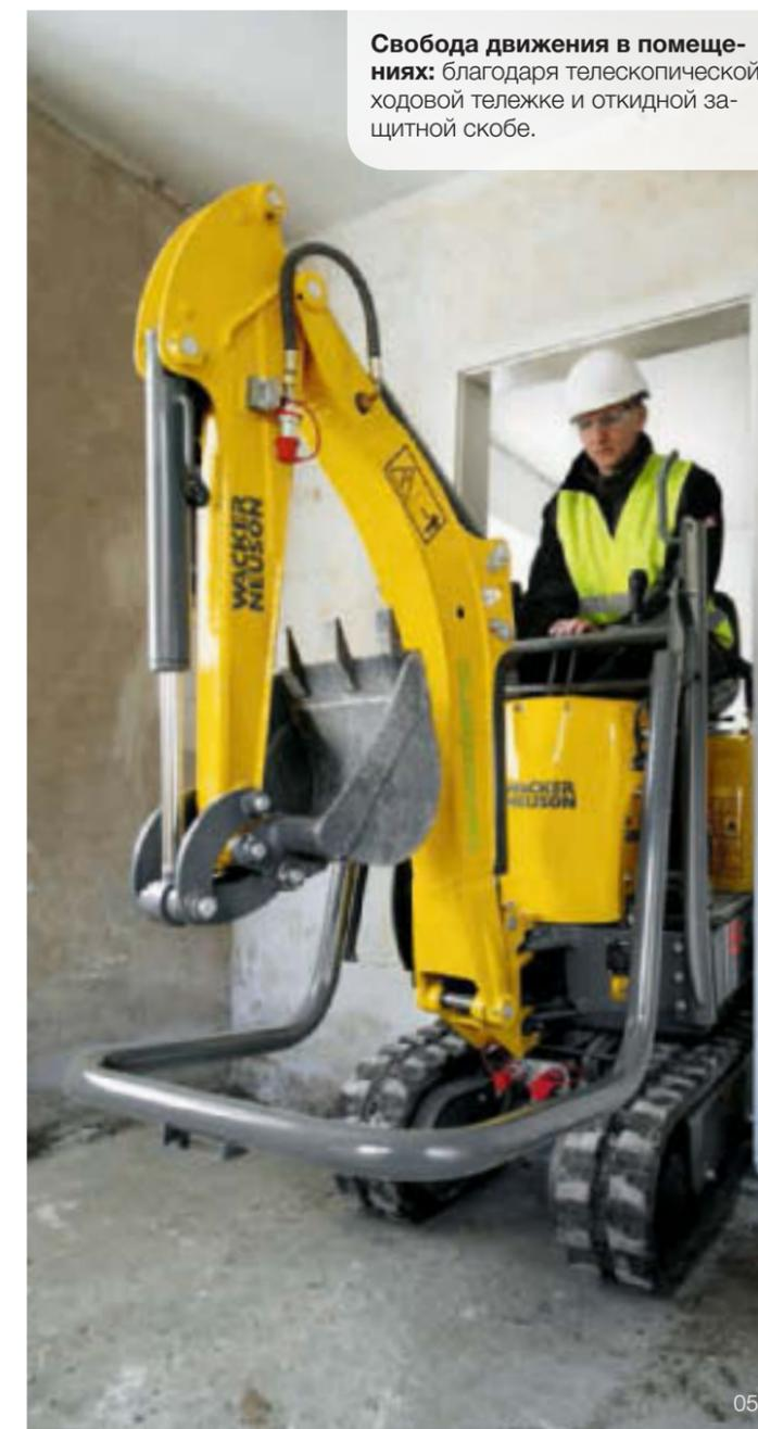
**Свобода движения в помещениях:** благодаря телескопической ходовой тележке и откидной защитной скобе.
