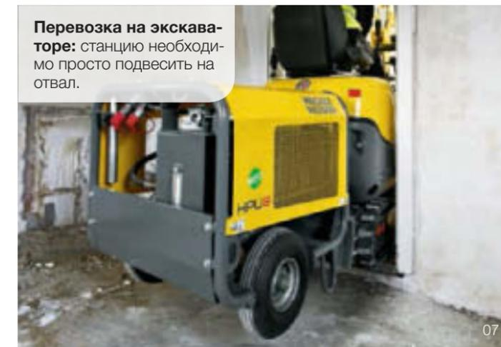
**Перевозка на экскаваторе:** станцию необходимо просто подвесить на отвал.
