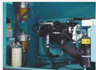
● Противопожарная перегородка отделяет насосное отделение от двигателя
