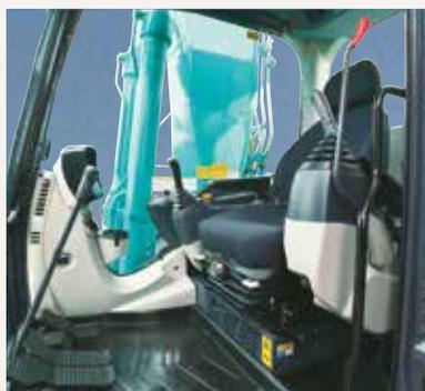
Удобный вход и выход благодаря широкому дверному проему кабины. Предохранительный запорный рычаг объединен со стойкой рычага управления.
