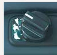
Возможен выбор между тремя различными гидравлическими контурами, адаптированными под ковш, клещи или отбойный молоток. Необходимый режим работы навесного оборудования можно
