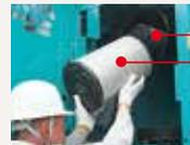
Особенностью этого фильтра является наличие двух фильтрующих элементов большой емкости, что позволяет обеспечивать чистоту двигателя даже в пыльных условиях.
