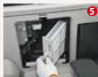
Фильтр кондиционера воздуха можно легко снять для чистки без применения инструмента.
