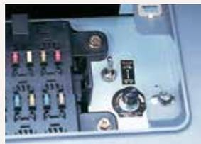
В случае непредвиденных неполадок в мехатронной системе управления ITCS машина сможет продолжать работу благодаря системе аварийного запуска. Режимы копания также автоматически переходят на аварийный режим работы, чтобы копание продолжалось в течение определенного времени, до прихода технического специалиста, который восстановит работу основной системы.
