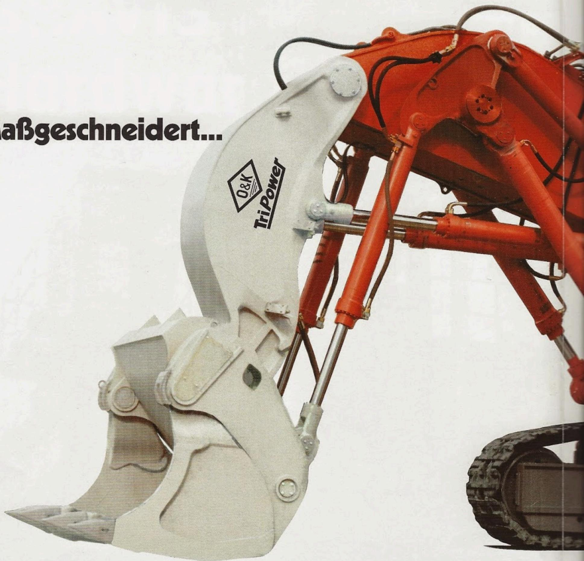
... für 170 bis 240 sht. Muldenkipper. Der RH 200 kann in 4 bis 6 Spielen diese Muldenkipper beladen. Damit können Muldenkipperflotten dieser Größenklassen höchst wirtschaftlich betrieben werden. Der RH 200 ist ein Großhydraulikbagger für das Laden von gesprengtem Haufwerk, aber auch für das Lösen und Laden von ungesprengten Böden in Großtagebauen. Hohe Ladeleistung, große Mobilität und optimale Verfügbarkeit realisiert dieser Bagger mit modernster und verlässlicher Technik.
