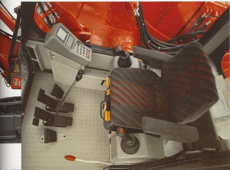
Ergonomische Anordnung der Pedale – Zusatzpedal für Verstellvorrichtung.
