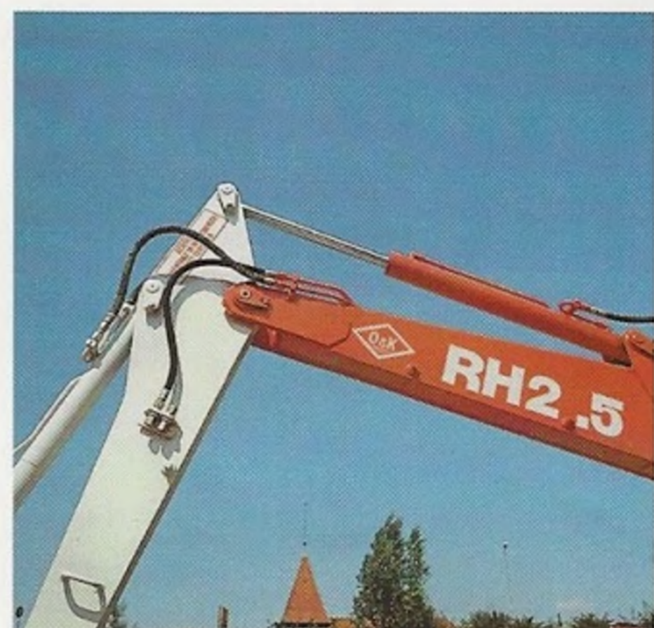
Übersichtliche Verrohrung und saubere Schlauchführungen: Problemlose Umrüstung auf Zusatzgeräte, wahlweise mit Schnellkupplungen.
