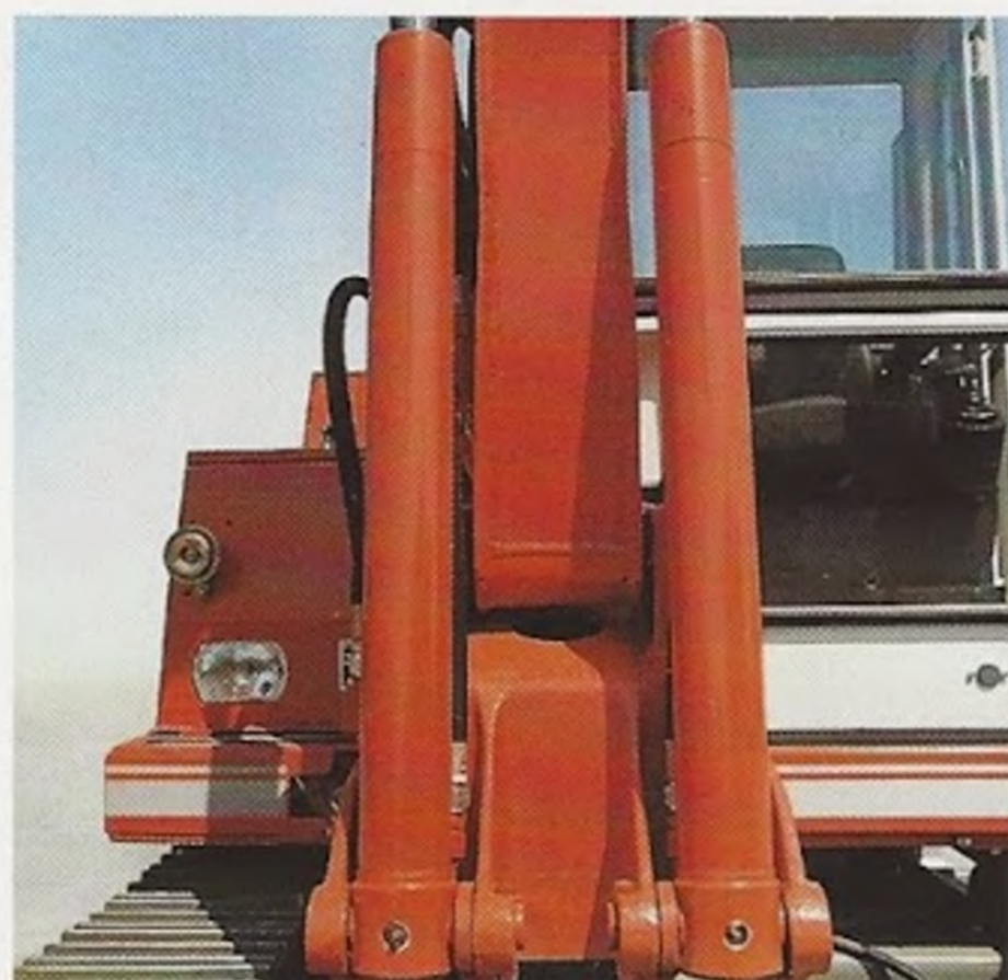
Längst nicht selbstverständlich in der unteren Kompaktbagger-Klasse: zwei doppelt beaufschlagte Zylinder am Ausleger.
