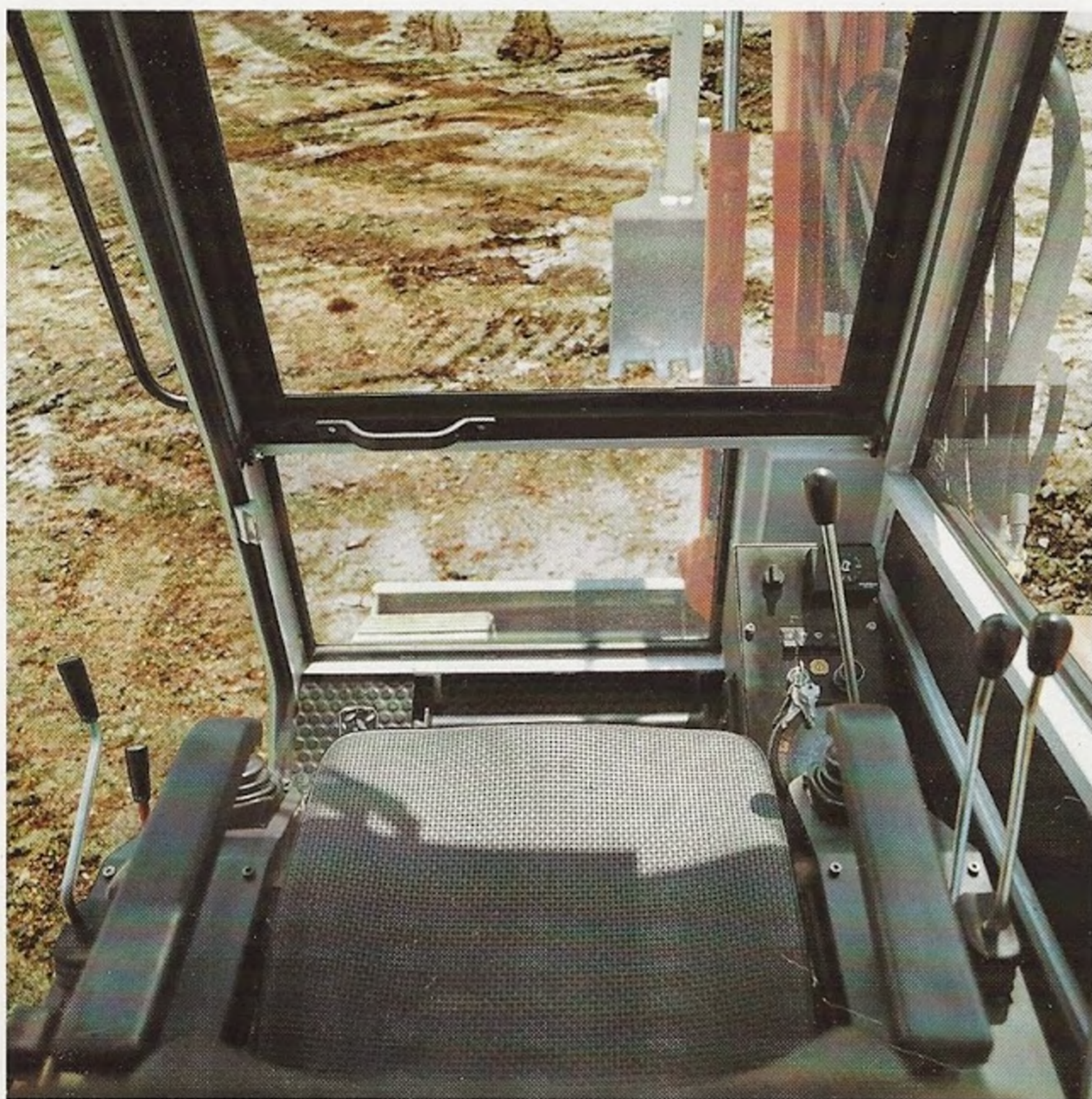
Großzügig dimensioniertes Cockpit mit Sicherheitsverglasung für hohe Fahrerleistung.
