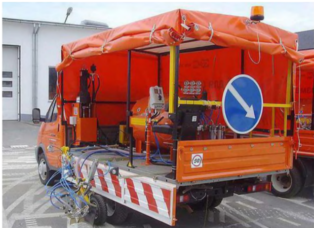
Разметочная машина РДТ-220 на базе автомобиля «Газель»
