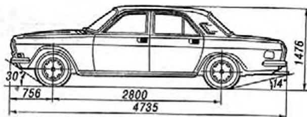
Рис. 1. Автомобиль ГАЗ-24-10 "Волга" и его габаритные размеры
