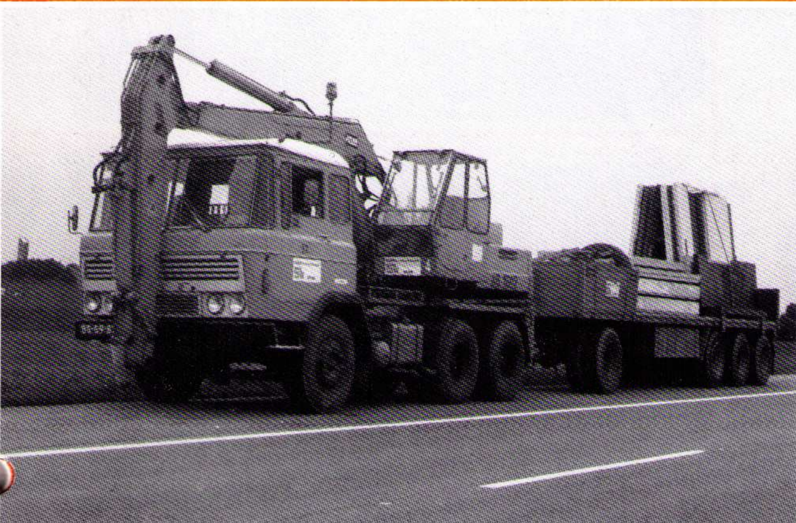
Baggeroberwagen, aufgebaut auf einem Tiefladerzug in Holland
