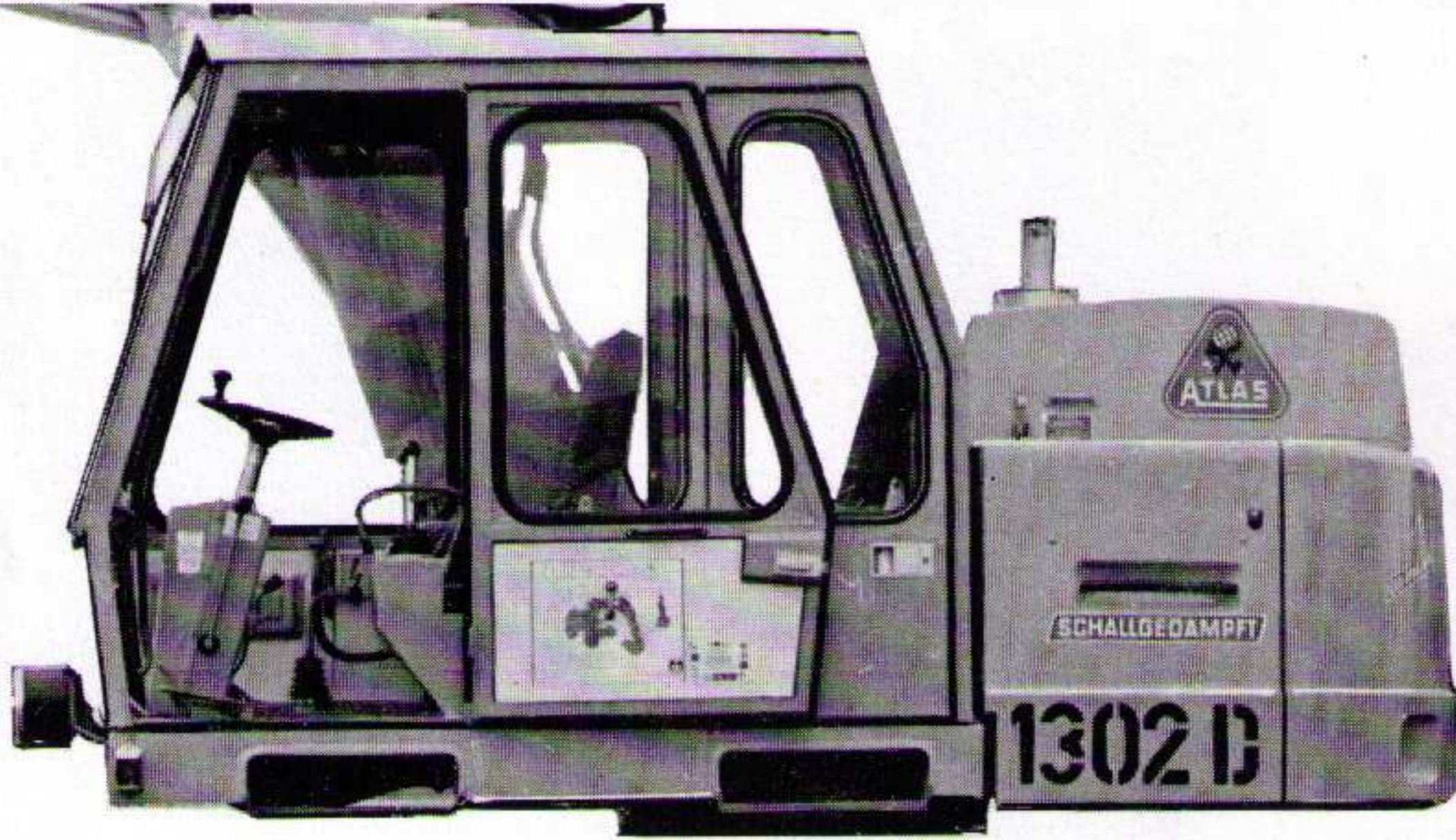
Doppelkabine mit Sitz für Zugbegleiter im Zweiwegebagger
