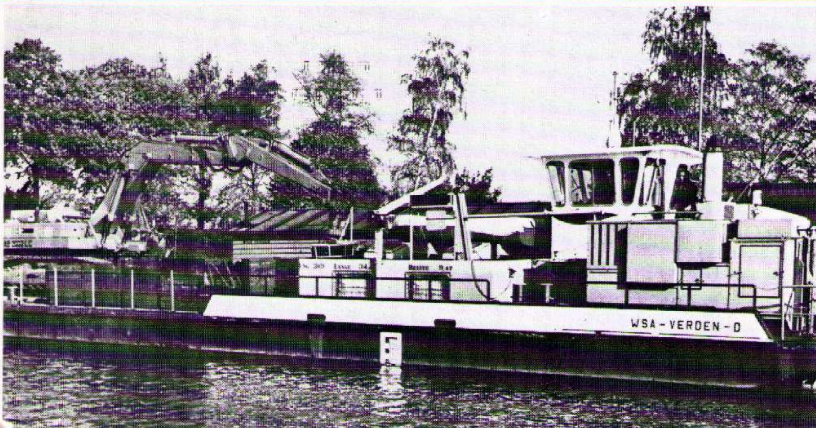
Bagger im Bordeinsatz bei Wasser- und Schifffahrts-Ämtern
