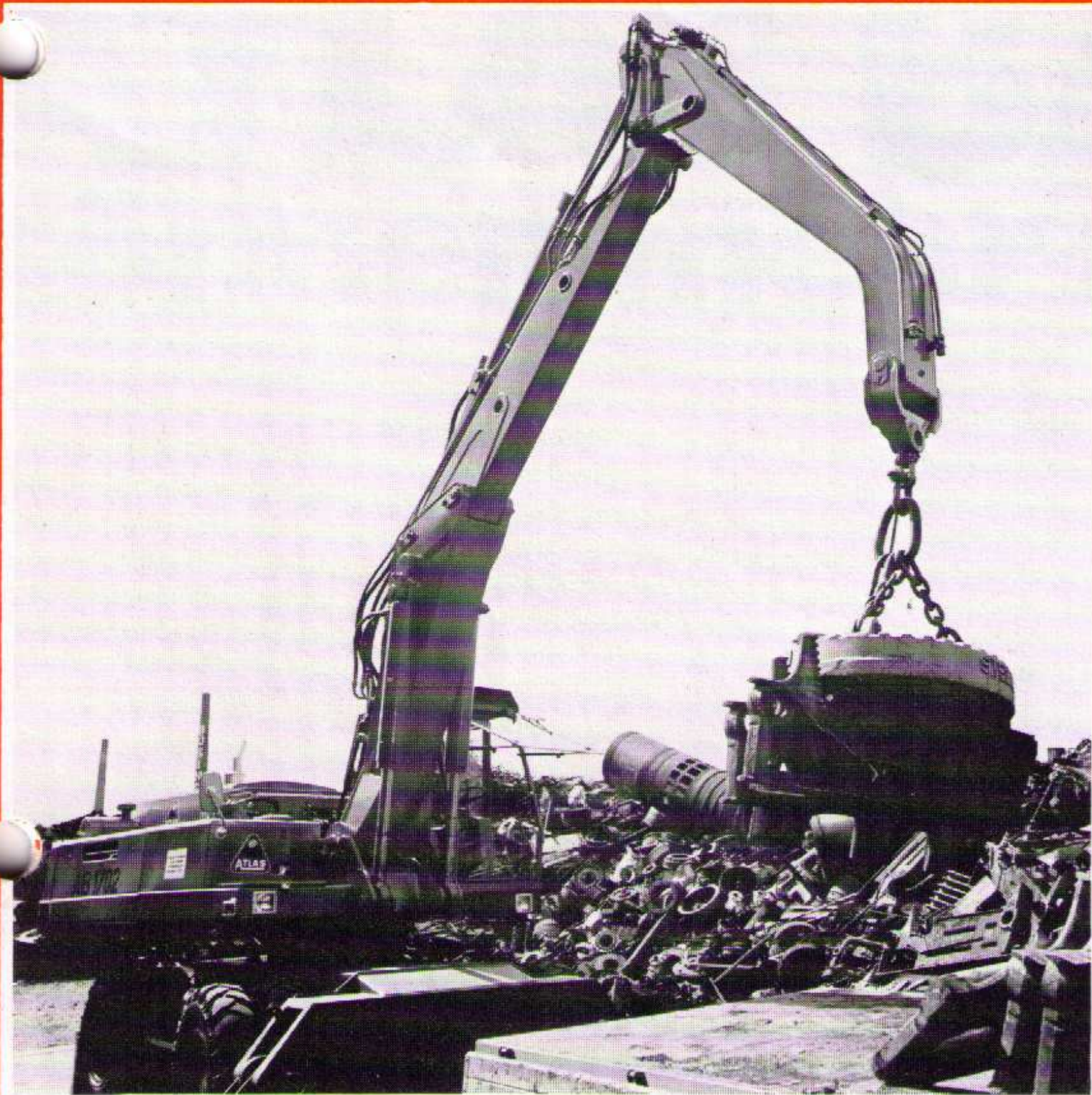
Schrottplatzeinsatz mit Lasthebemagnet an gekröpftem Knickarm
