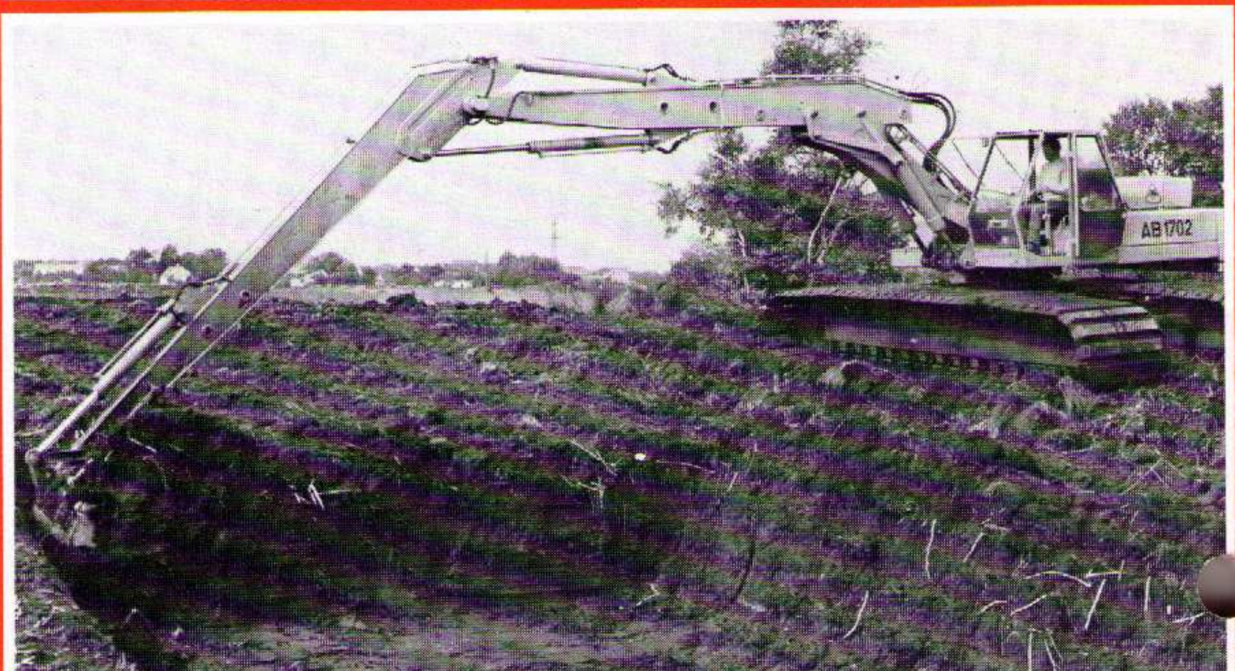
Grabarbeit mit extrem langer Auslegerkombination
