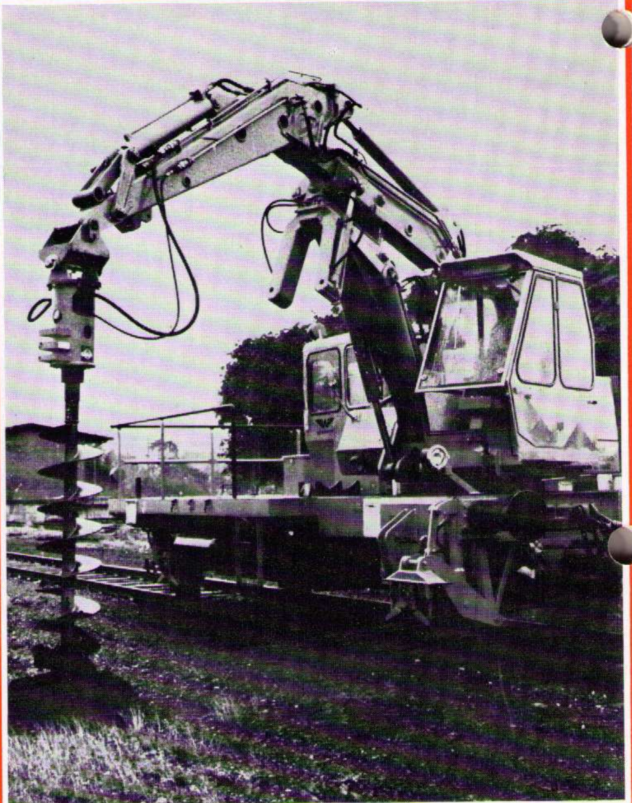
auf Gleisbaufahrzeug für Erdbohrarbeiten
