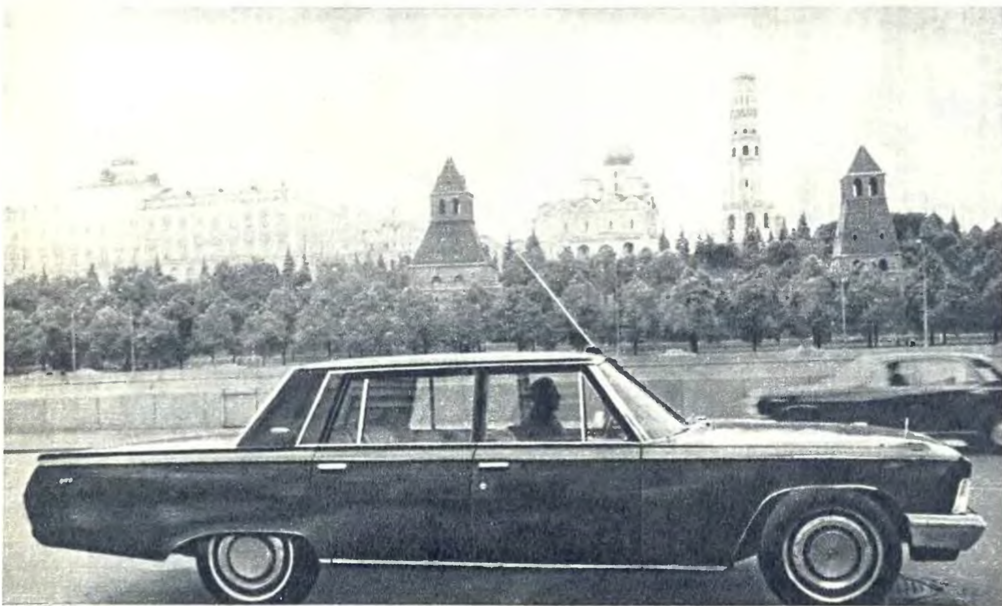
Новый легковой ЗИЛ, снабженный современным восьмицилиндровым двигателем рабочим объемом 6959 см 3 и мощностью 300 л. с. при 4400 об/мин, способен развивать скорость 200 км/час.
