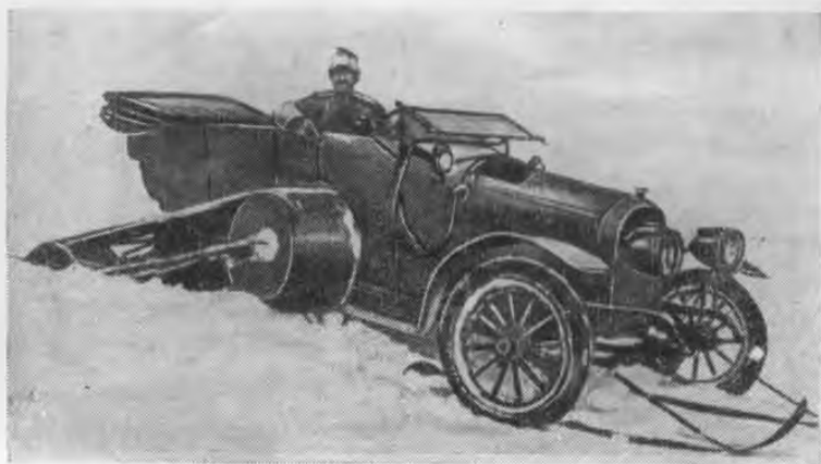
Рис. 26. Автомобиль «Руссо-Балт» с гусеничным двигателем системы инж. А. Кегресса
