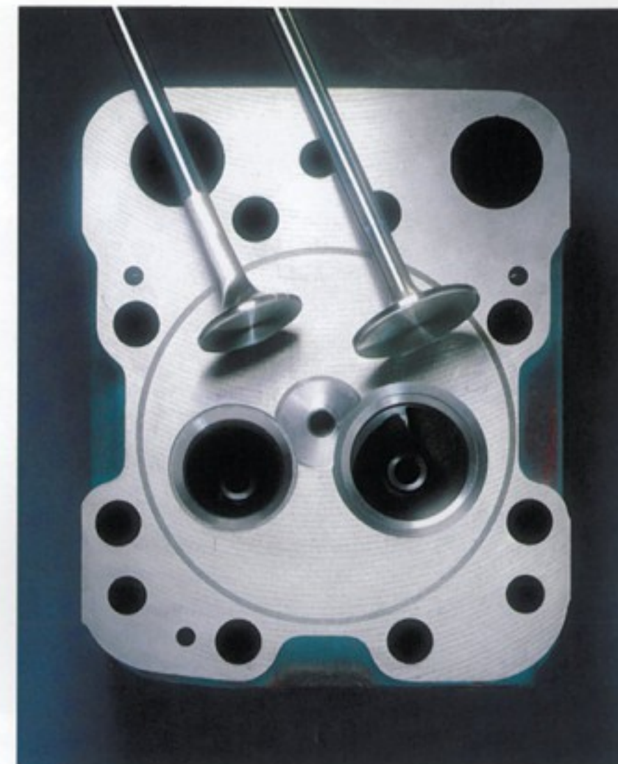
Cilinderkop met kleppen in de 14-liter motor. Dankzij de vorm van het inlaatkanaal is de werveling in de verbrandingskamer uitstekend.
