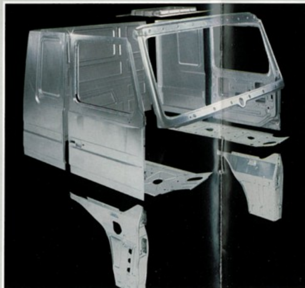
Verzinkte cabinebeplating zorgt voor een perfecte bescherming tegen corrosie.
