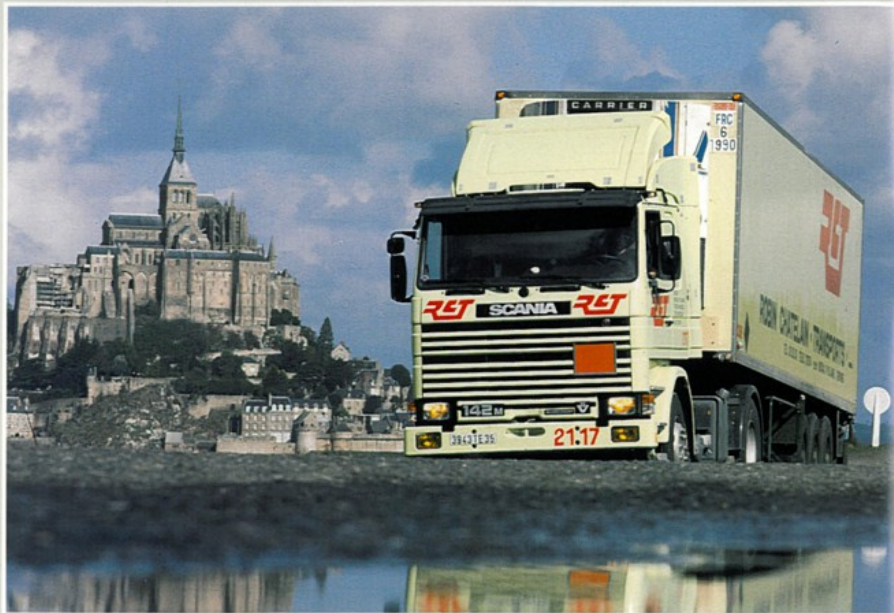
Scania R142MA 4x2. Trekker en drie-assige oplegger met gesloten opbouw voor koeltransporten.
