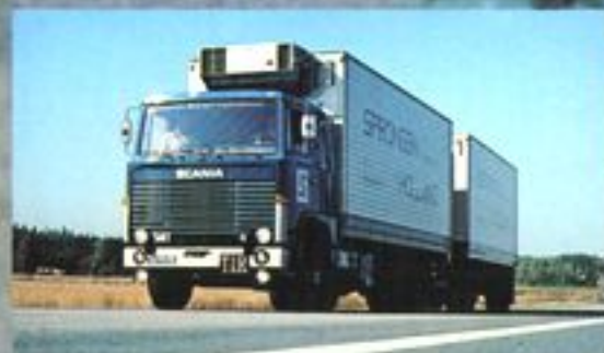
38 tons Scania LBS141 T.I.R. uitvoering met koelagregaat zowel op de voorwagen als op de aanhanger voor het transport
