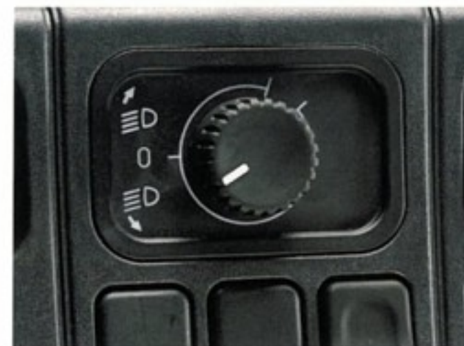
Die Höhenverstellung der Scheinwerfer läßt sich für maximale, blendfreie Beleuchtung einstellen. Der Fahrer und der Gegenverkehr werden dankbar sein.
