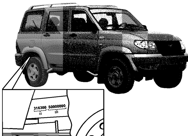
Рис. 1.3. Расположение идентификационного номера шасси
