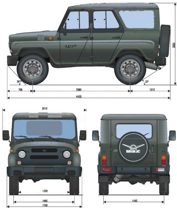
Рис. 1.2. Габаритные размеры автомобиля UAZ Hunter
