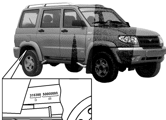
Рис. 1.3. Расположение идентификационного номера шасси
