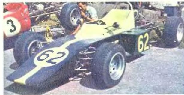
В соответствии с современными техническими требованиями к гоночным автомобилям у «Эстонии—19» бензобак изолирован от кокпита огнестойким материалом, машина снабжена четырехточечными ремнями безопасности, задним фонарем красного цвета, наружным выключателем системы зажигания (обозначен синим треугольником на левом борту) и наружным выключателем системы пожаротушения (обозначен буквой «Е» на правом борту).
