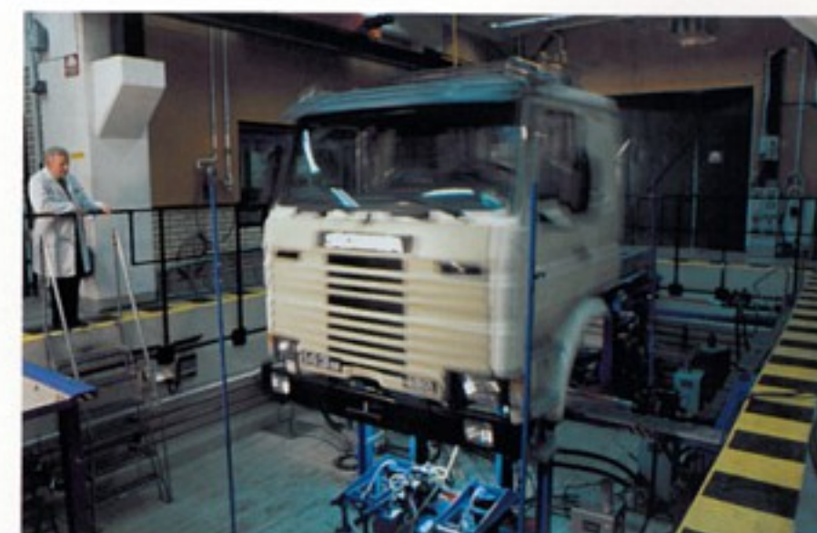
Auf dem Rüttelprüfstand können wir testen, wie sich die unterschiedlichsten Erschütterungen auf Ihre Arbeitssituation auswirken.
