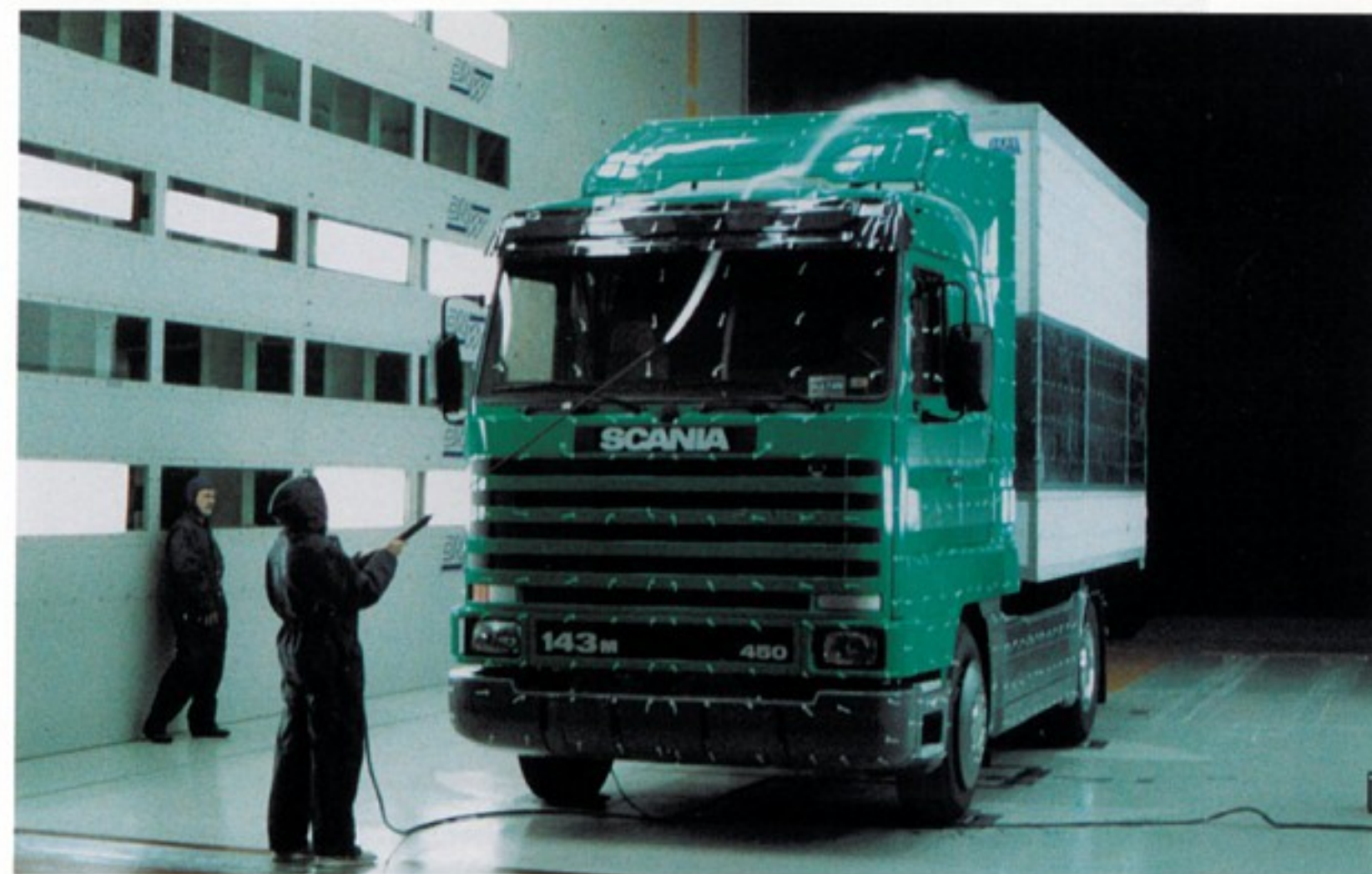
Tests im Windkanal mit Modellen im Maßstab 1:1 helfen uns, die Formgebung für minimalen Luftwiderstand und maximale Kraftstoffökonomie zu optimieren. Auf ein ansprechendes Aussehen legen wir natürlich ebenfalls großen Wert.
