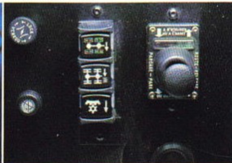
Bloqueio do diferencial inter-rodas e inter-pontes em todos os 6x4 e 6x6.
