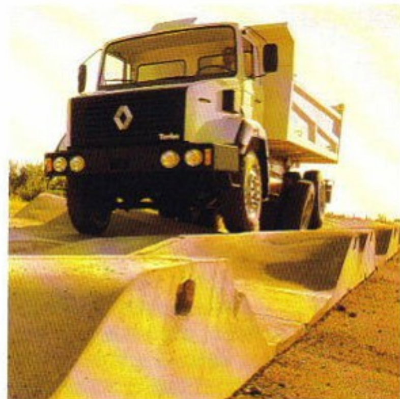
Teste de tortura na pista de ensaios Renault V.I.: percurso de bossas alternadas.
