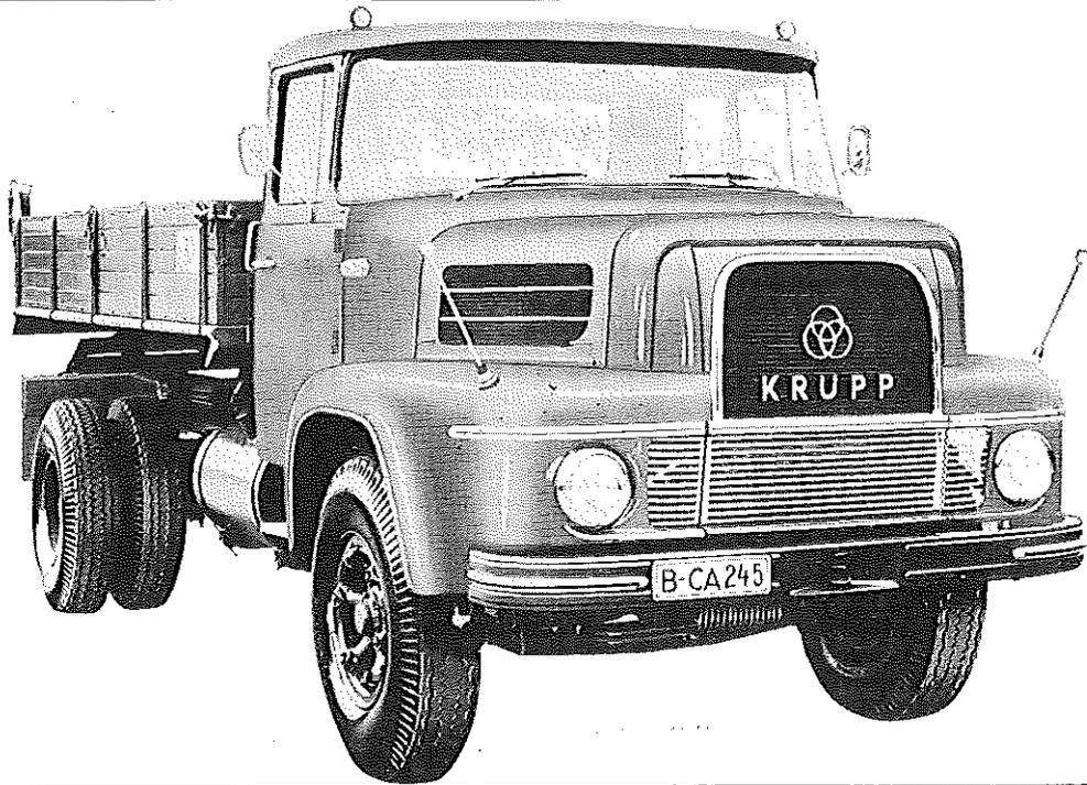
**Diesel-Motor D 459 · 4 Zylinder · 2-Takt · 186 PS bei 1950 U/min**
