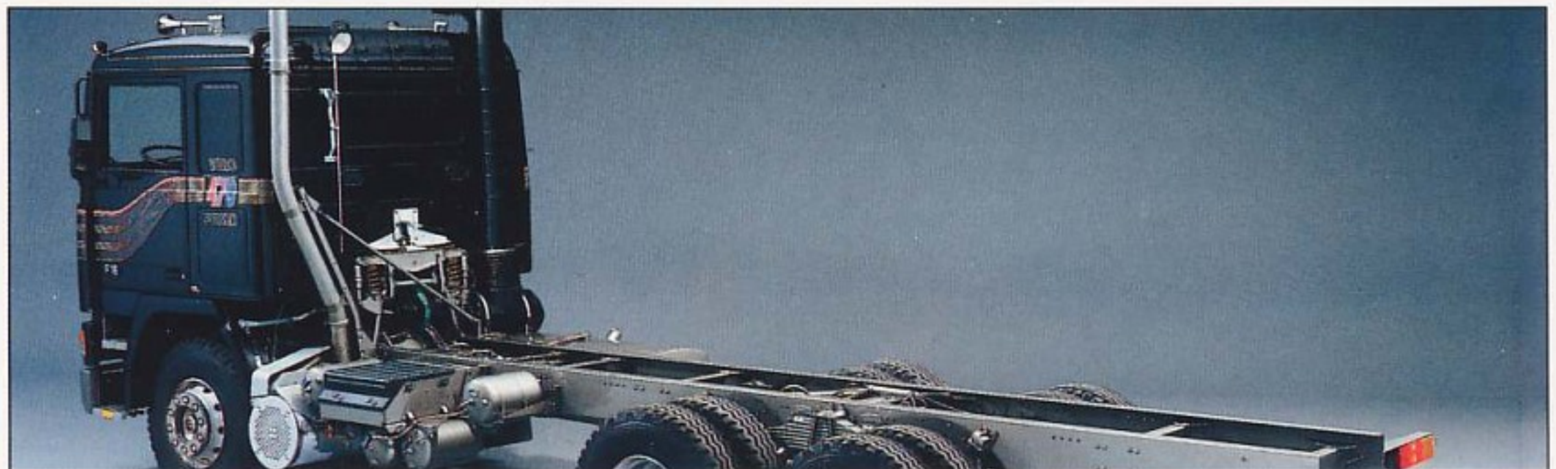
Frames met geheel vlakke bovenzijde, parallel over de gehele lengte en voorzien van voorgeboorde gaten. Eenvoudige, snelle en aanzienlijk goedkopere montage van de opbouw.
