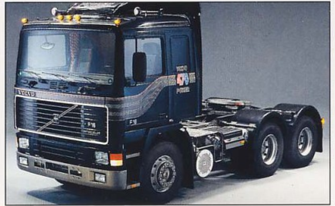
In windtunnel beproefde, aerodynamisch gevormde cabine. Lagere luchtweerstand en lager brandstofverbruik.
