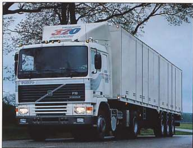
Trekker met hoog nuttig laadvermogen en grote brandstoftank. Veel ruimte, ook voor een gereedschapkist en reserveband.
