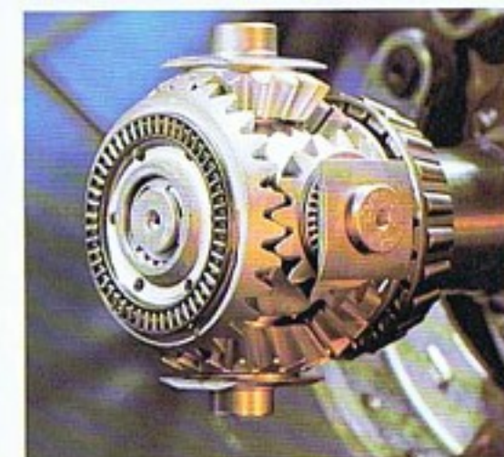
Achteras: geheel vrijdragende achteras met een extra naafreductie.
