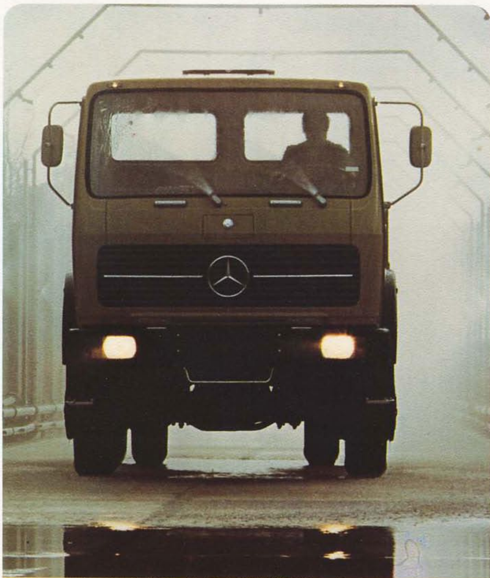
Kunstmatige moesson-regen. Ongeveer 70 liter water plenst per seconde neer op de proefbaan. Hier test men alle kleppen en luchtinlaatopeningen, alsook portieren en ramen op lekkage.
