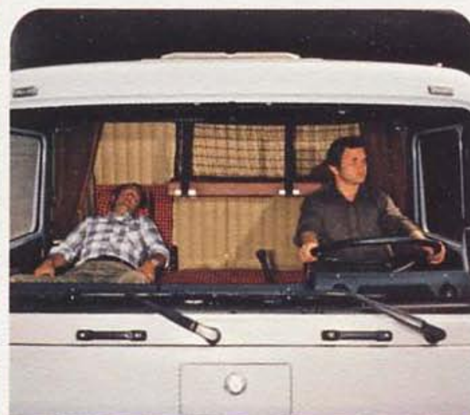
Achter de bijrijdersstoel is het bovenbed gedeeld. De bijrijdersstoel (met armleuningen en hoofdsteun) kan daardoor ver achterover worden gezet; een echte relax-stoel voor onderweg.
