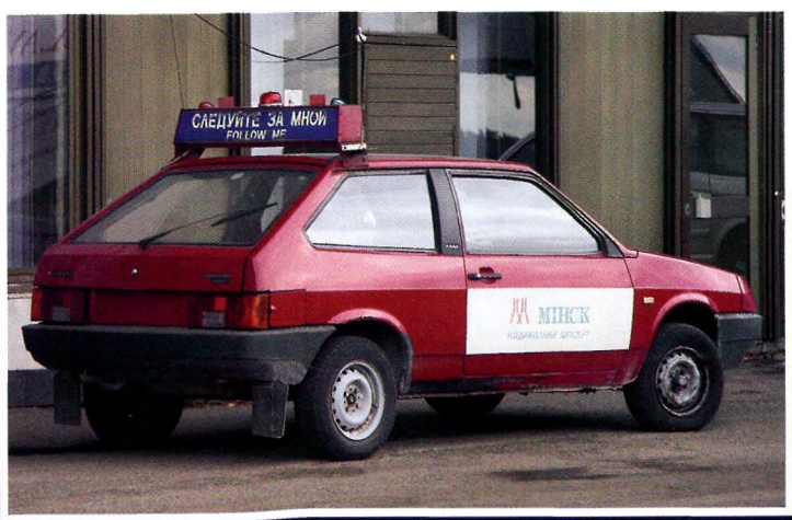
Автомобиль сопровождения самолетов «Эскорт-2108» на базе ВАЗ-2108
