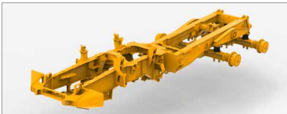
Шасси из высокопрочной стали обеспечивает прочность и жесткость без излишнего веса.
