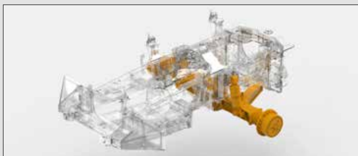
A-образная рама передней подвески оснащена гидропневматическими стойками, снижающими воздействие на самосвал неблагоприятных дорожных условий. Улучшенная подвеска сидения обеспечивает снижение нагрузок на оператора.
